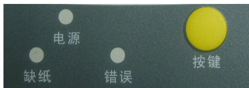
图2-2. ICOD T58控制面板示意图
