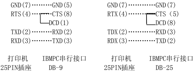
图2-4. 1. T58打印机串行接口与PC串行口连接示意图
